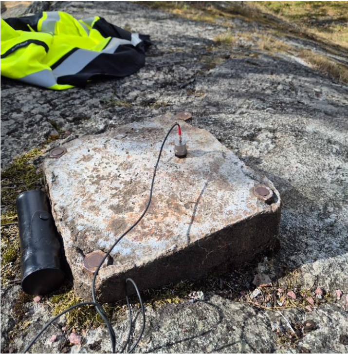
Figur 7 Mät punkt 3 - accelerometer fästes på ett plant flaggstångsfundament av gjuten betong, fundamentet var ingjutet i berget.
