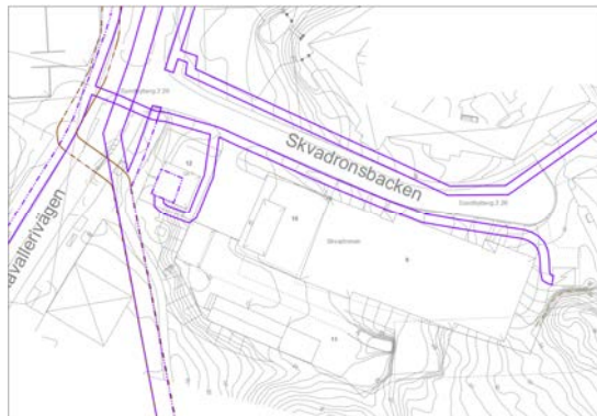
Figur 1 Gällande ledningsrätter inom planområdet, brun linje är ledningsrätt tillhörande Norrvatten. Lila linjer är övriga ledningsrätter.
