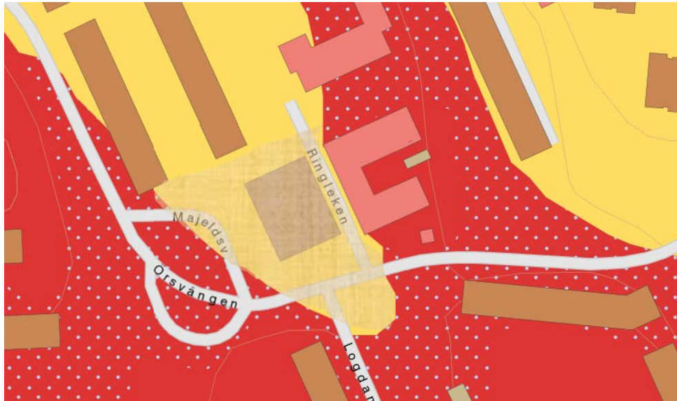
Figur 2. Utdrag ut geologiska kartbladet, SGU. Röd färg motsvarar berg, blåa prickar motsvarar ett tunt eller osammanhängande lager morän, gul motsvarar postglacial lera. Inom den rasterade ytan tyder inventerade undersökningar på att lerlagrets sannolikt skiftats ut i samband med exploatering.
