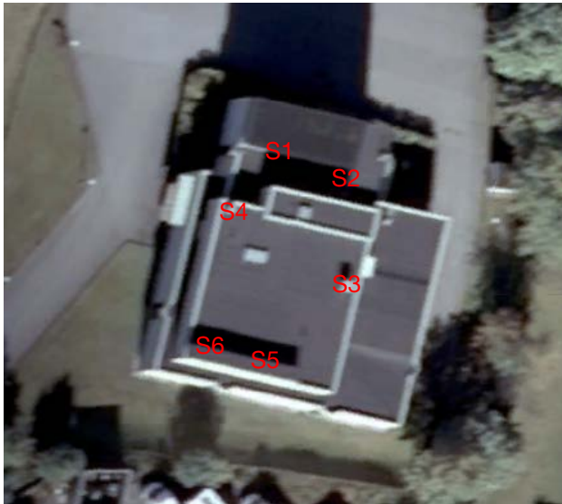
Figur 2. Bullerkällor på nätstationens tak.
