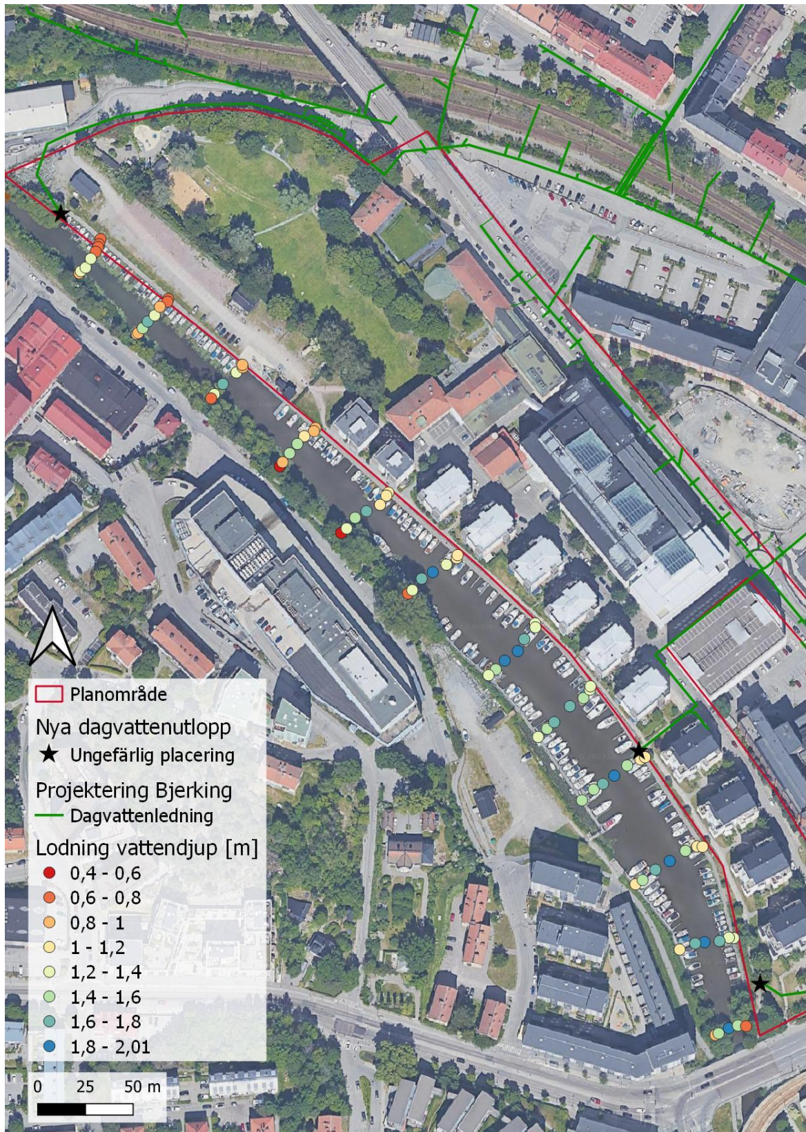
Figur 11. Lodning av bottennivå (RH2000) vid 12 sektioner i Bällstaviken av Golder Associates AB (2022a). Botten motsvarar nivån för dyn som uppskattas vara 1–2 m och därefter mer fast botten. Vattendjup baserat på lodad botten och medelvattenstånd (+0,86 m) (Stockholms Hamnar, 2022). Bakgrundskarta: Google Satellite (u.å.).
