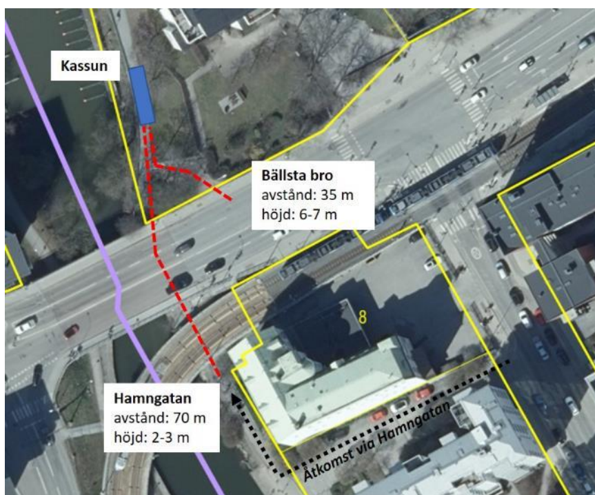
Figur 11. Alternativ för uppställning av slamtömningsbil och åtkomst med servicefordon för mottagningskassun vid Bällsta bro. Bakgrundskarta: Flygfoto med fastighetsgränser © Lantmäteriet
