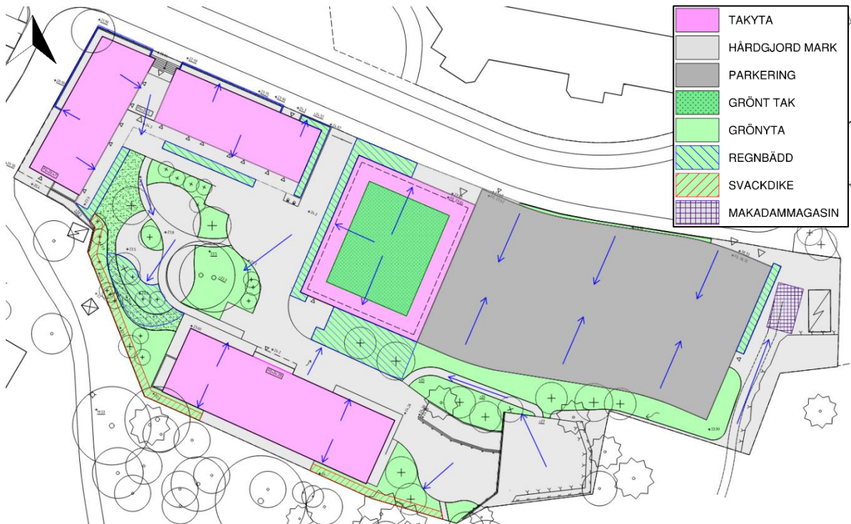
Figur 5-6. Avvattningsplan för Skvadronen 10. Ungefärliga flödesriktningar markerade med blå pilar.
