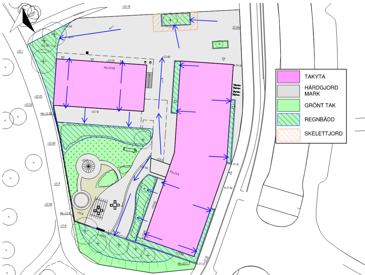
Figur 5-3. Avvattningsplan för Artilleristen. Ungefärliga flödesriktningar markerade med blå pilar.
