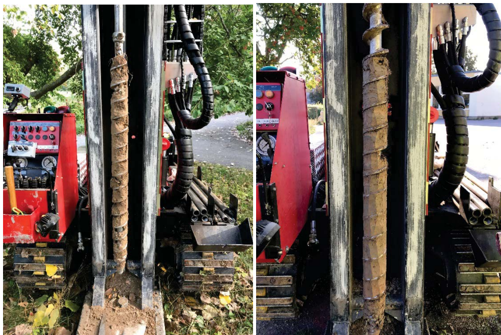
Figur 2: Foton från fältarbete: T.v. fyllningsjord över lera i provpunkt 18GA112. T.h. lera i provpunkt 18GA110.
