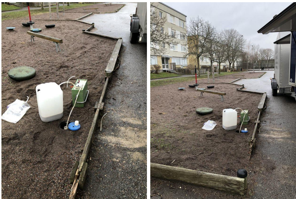
Figur 1: Renspumpning av grundvattenrör vid Örskolan.
