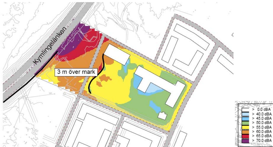
Figur 9. Detalj av bullerkartering, scenario 2. En tre m lokal skärm och 2 m hög skärm utmed Kymlingelänken. Ekvivalent ljudnivå markplan.
