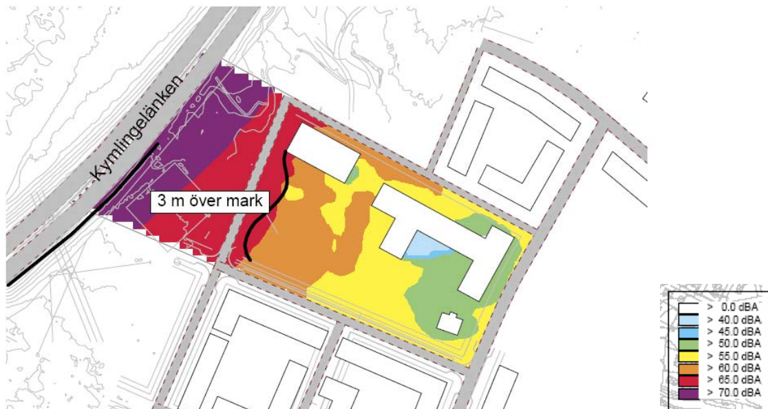
Figur 10. Detalj av bullerkartering, scenario 2. En tre m lokal skärm och 2 m hög skärm utmed Kymplingelänken. Ekvivalent ljudnivå plan 3.
