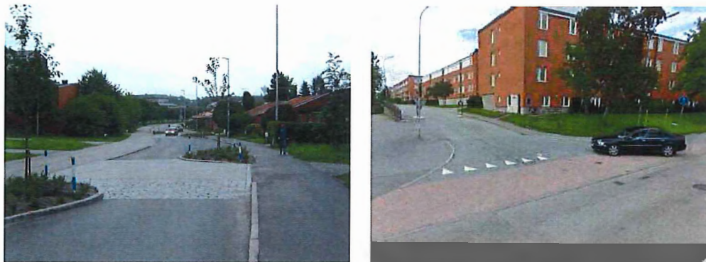
Exempel på trafiksäkerhetsåtgärder med markerad och genomgående gångbana. Civit
